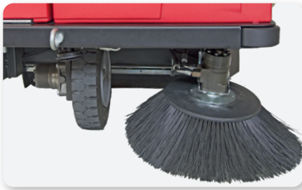
Braccio spazzola laterale sinistro Left side brush arm Brazo de cepillo lateral izquierdo
