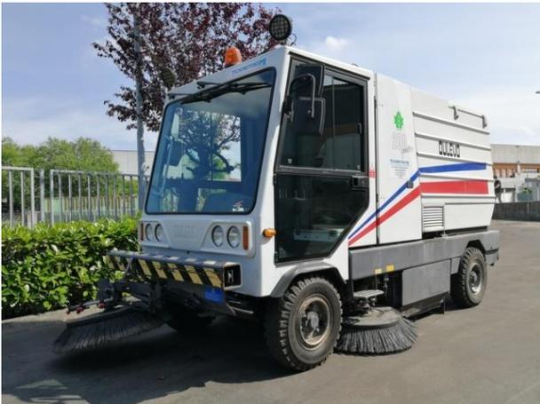
DULEVO 200 QUATTRO è una robusta spazzatrice stradale targata, dotata del sistema “Meccanico-Aspirante-Filtrante”.
